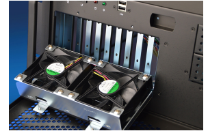
Herausnehmbarer Lüfterkäfig in der Frontblende des IPCs 404
