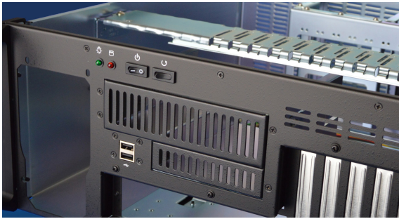
In der Frontblende integrierte Laufwerkslots, USB 2.0, Stromversorgungsslot und Bedienelemente
